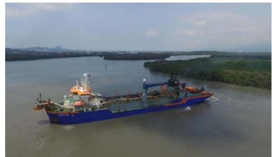
Figura 4 - Draga Ham 316 trabalhando na abertura da CAD
