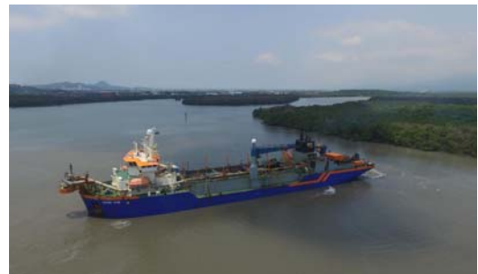
Figura 4 - Draga Ham 316 trabalhando na abertura da CAD
