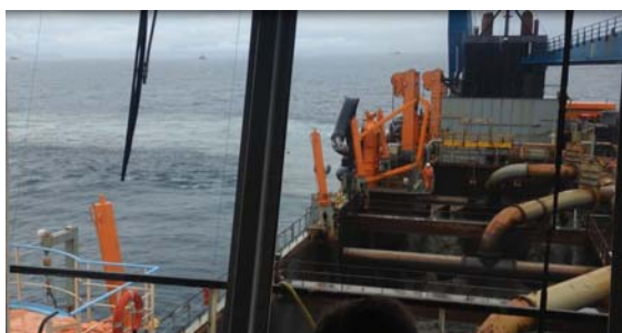
Figura 3 - Abertura da cisterna no local de despejo (PDO) autorizado pela CODESP
