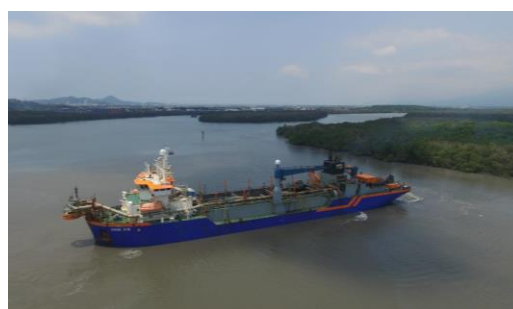
Figura 4 - Draga Ham 316 trabalhando na abertura da CAD
