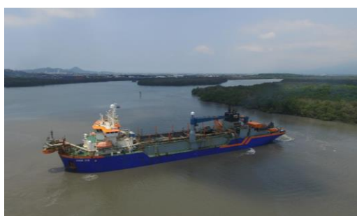
Figura 4 - Draga Ham 316 trabalhando na abertura da CAD
