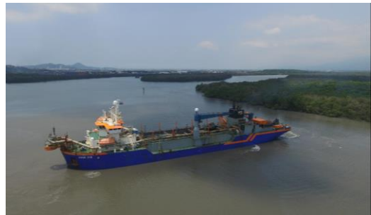
Figura 4 - Draga Ham 316 trabalhando na abertura da CAD
